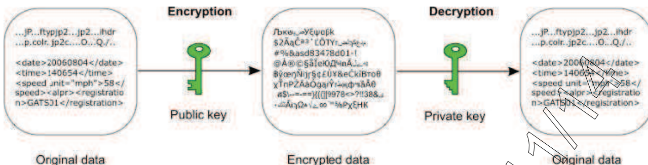
La figura mostra una vista semplificata dell'algoritmo di firma digitale
